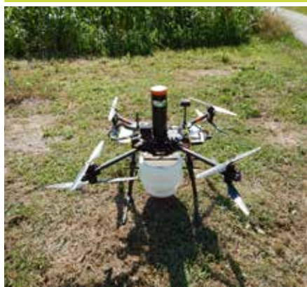
Figura 16. Drone con serbatoio per lancio di Trichogramma brassicae
